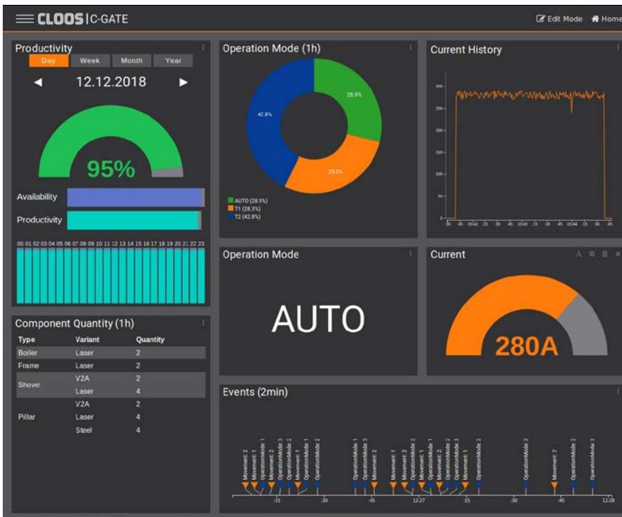
Bild 2: Das Dashboard des neuen C-Gate bietet vielfältige Funktionen zur Visualisierung von Schweiß- und Roboterdaten.
